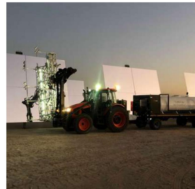
velocidades requeridas durante las labores de limpieza, haciéndolo compatible con el alto régimen de giro de la toma de fuerza del chasis.
