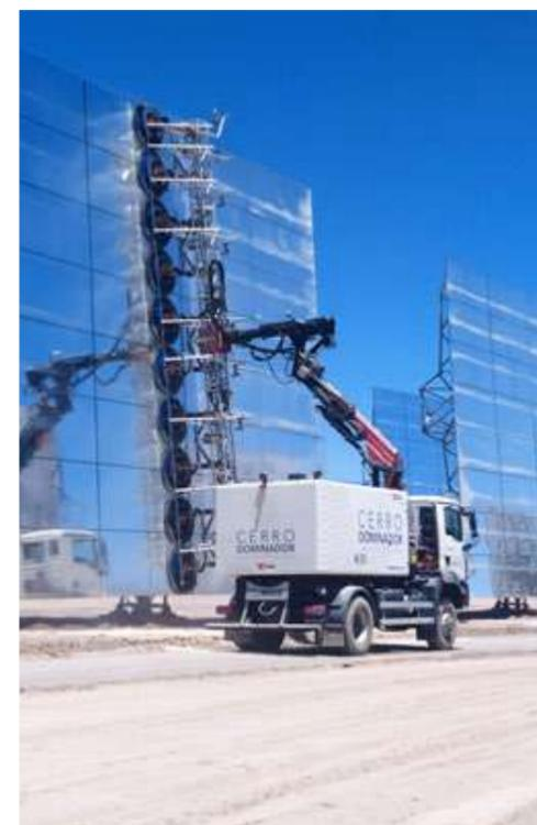
Feniks nace de la mano de un equipo con años de experiencia en el diseño y fabricación de vehículos de limpieza urbana, contraincendios y limpieza y mantenimiento de plantas termosolares. Para éstas ha desarrollado diversos modelos en función de la tecnología, además de remolques para el transporte de colectores.
